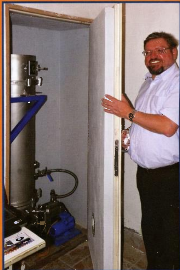
↑ Kyvadlo ve vakuové komoře ve sklepní místnosti; všimněte si tloušťky dveří.
