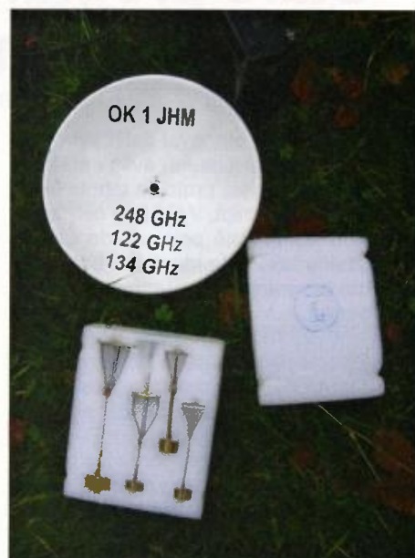
Obr. 3. Parabola OK1JHM pro tři pásma a sada výměnných ozařovačů
