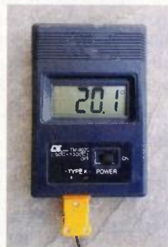
Obr. 3. Termočláňkový měřič teploty
