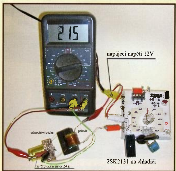
Obr. 10. Fotografie zkušební instalace napájecího zdroje s FET (dole)
