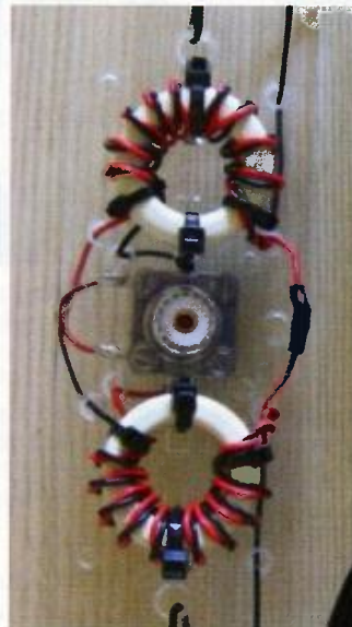
Obr. 2. Dvoujádrový balun s dvojicí zkroucených vodičů
